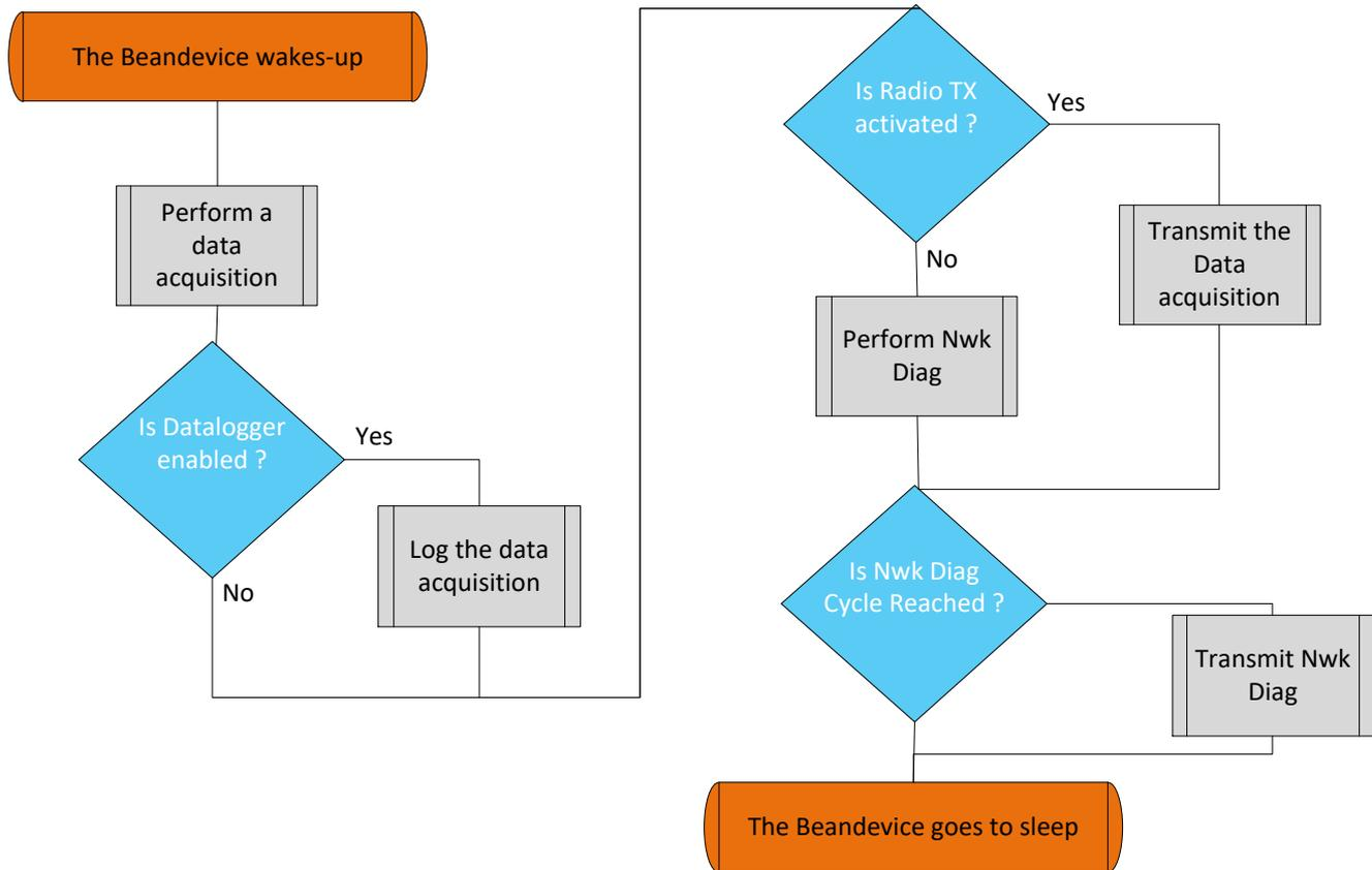
**7.2 « ALARM » DATA ACQUISITION MODE WITH SLEEP WITH NETWORK LISTENING POWER MODE CONFIGURATION**
