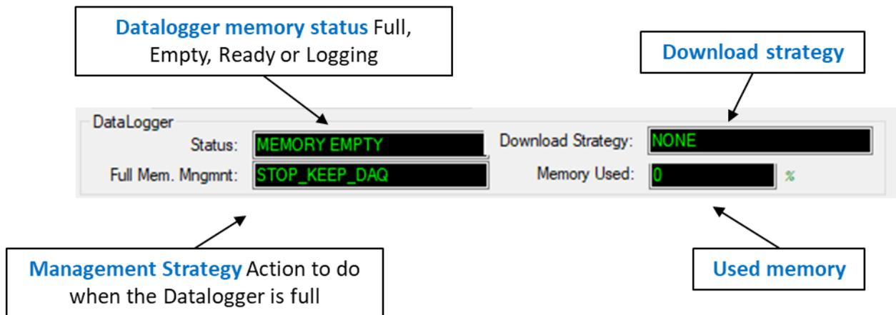
**Figure 56: Datalogger frame**
