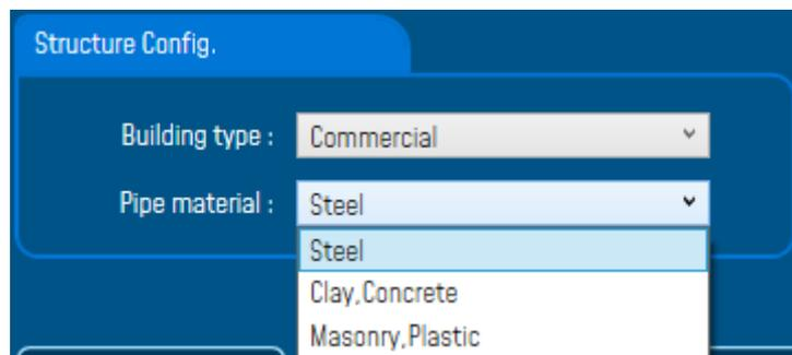
**Figure 172: DIN 4150-3 Configuration**
